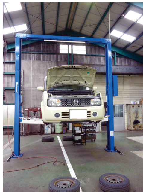
導入設備（門型リフト）
